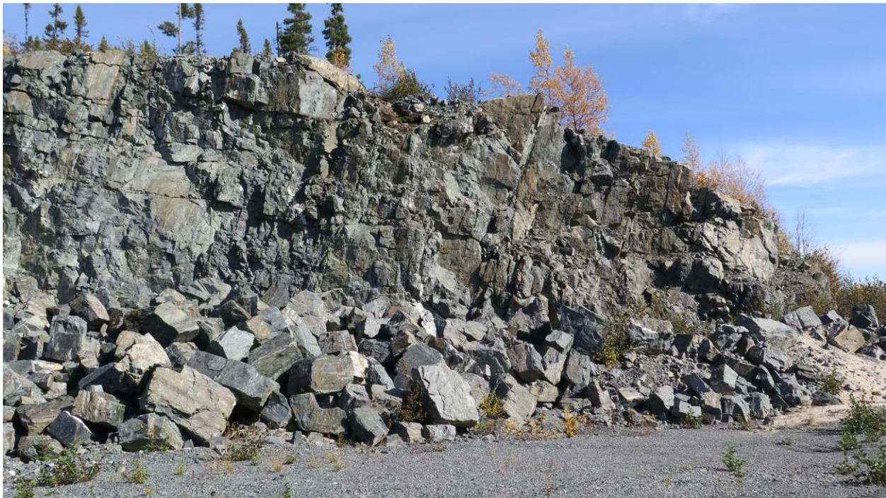
L'abrasivité du roc a été mesurée à l'aide de l'essai Cerchar. Selon les résultats de cet essai, le roc est très abrasif. De plus, selon les résultats des essais de résistance à l'usure et aux chocs effectués à l'aide des instruments Los Angeles et Micro-Deval, ce matériau est de catégorie 1. Les résultats de ces essais sont présentés à l'annexe 2.
