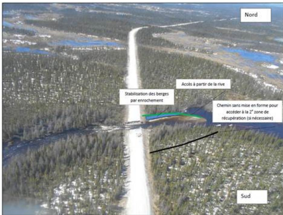
Figure 1. Aires de circulation de la machinerie et accès en rive.
